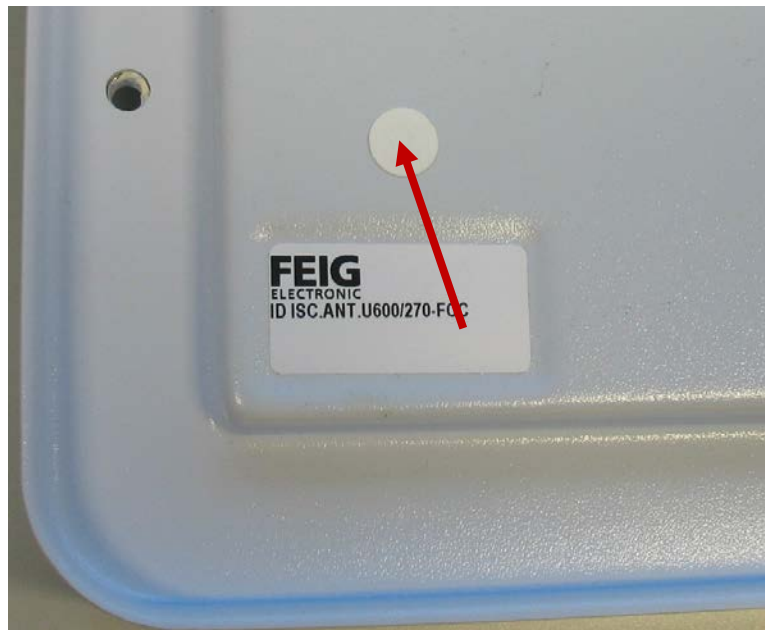
Abbildung 4: Membran zum Druckausgleich
